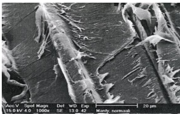
Kuva 2. Käsittelemättömän männyn solukon pintarakennetta tuhatkertaisena suurennoksena.
