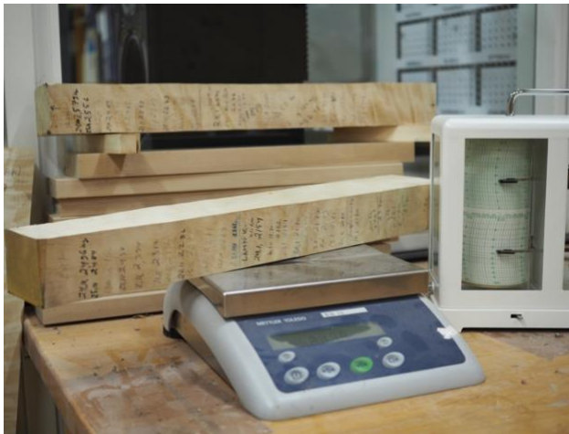
Kosteustasapainon mittaus tarkkuusvaa'alla. Huoneilman kosteutta tarkkaillaan kosteusmittarilla. Kuva Rauno Nieminen.
